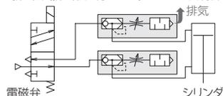
● スピードコントローラによる速度制御
