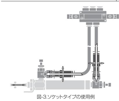
図-3. ソケットタイプの使用例
